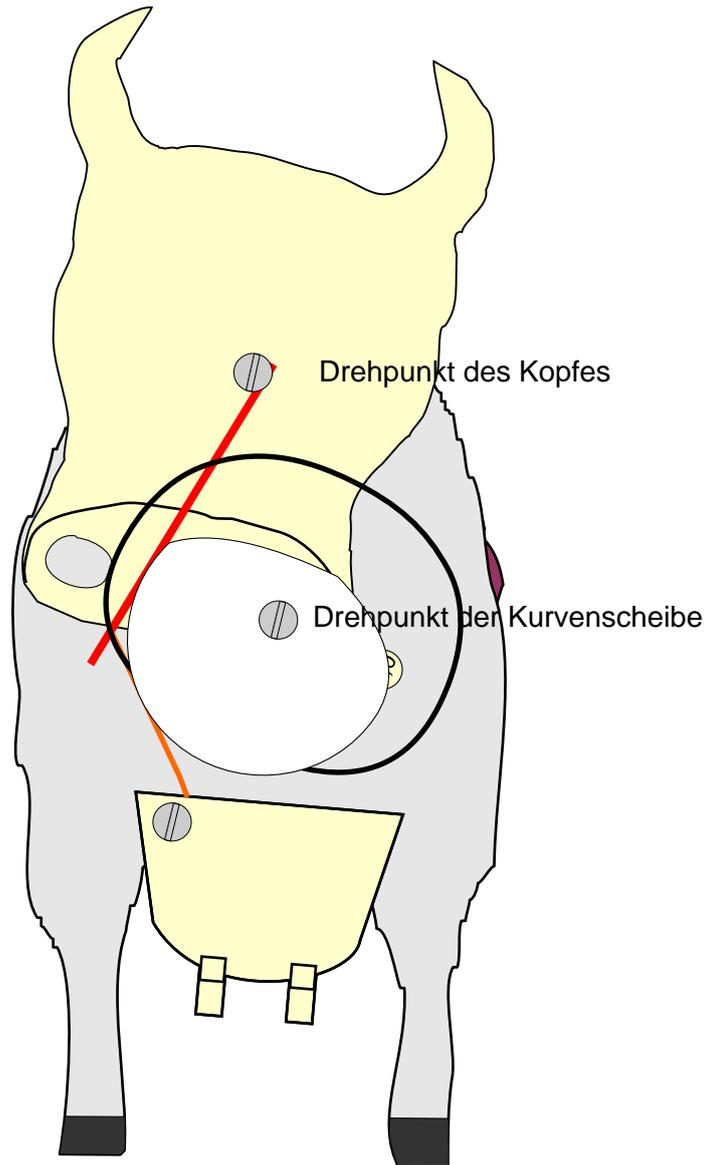
Die Drehbewegung des Kopfes wird durch die untere, kleine Kurvenscheibe gesteuert.
