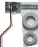
Schrauben M3 dienen als Achse und zur Befestigung. In 2,5 mm Bohrung sind sie fest einzuschrauben.
