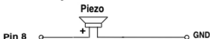
Abbildung 22: Schaltplan für Signal mit Piezo
