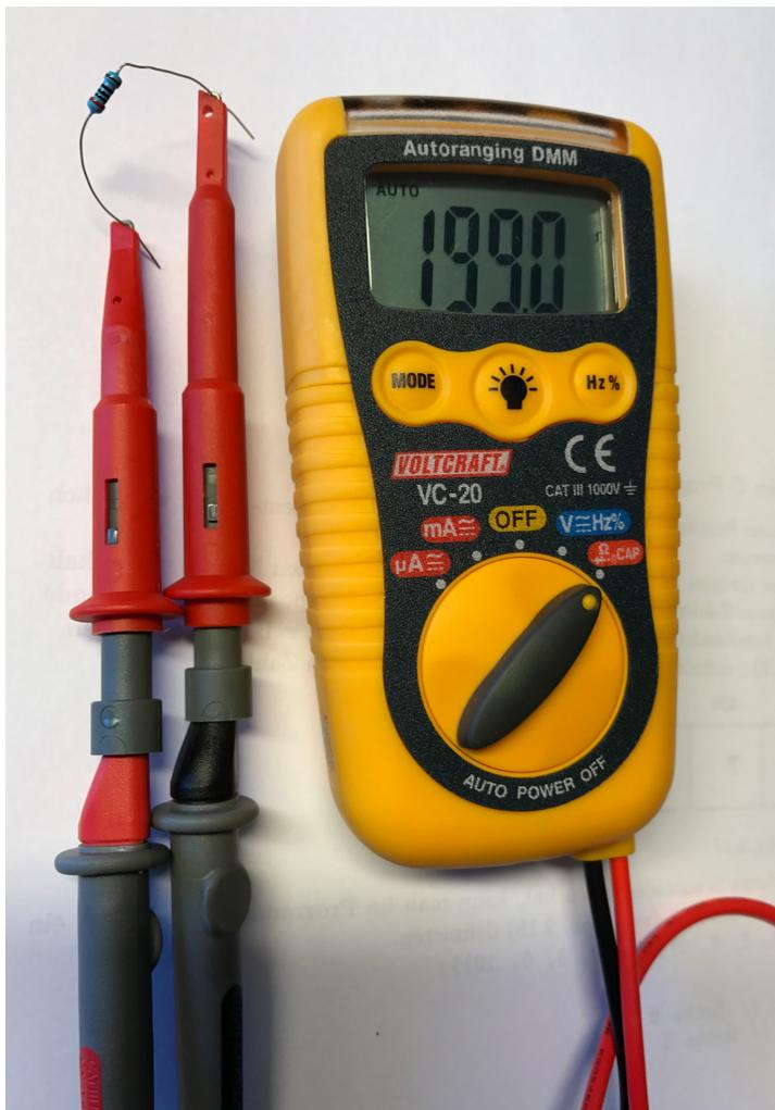
Abbildung 16: Digitalmultimeter
