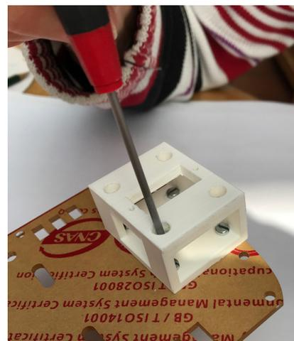
Servo-Halterung jetzt auf der Oberseite mit 4 Schrauben (3 x 20 mm) aus dem Baumarkt befestigen.
