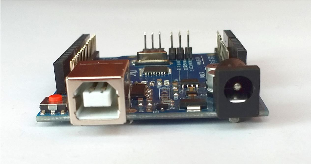
Der Uno R3 verfügt über zwei, auf dem Board befindliche Festspannungsregler mit +5V und 3.3V Spannung. Durch den 2.1mm Stecker können Sie diese mit Strom versorgen. (Wir empfehlen eine Eingangsspannung von 7 – 12 V). Durch die am Uno vorhandene Beschaltung, stehen auf dem Board sowohl stabile 5V als auch stabilisierte 3.3V zur Verfügung.
