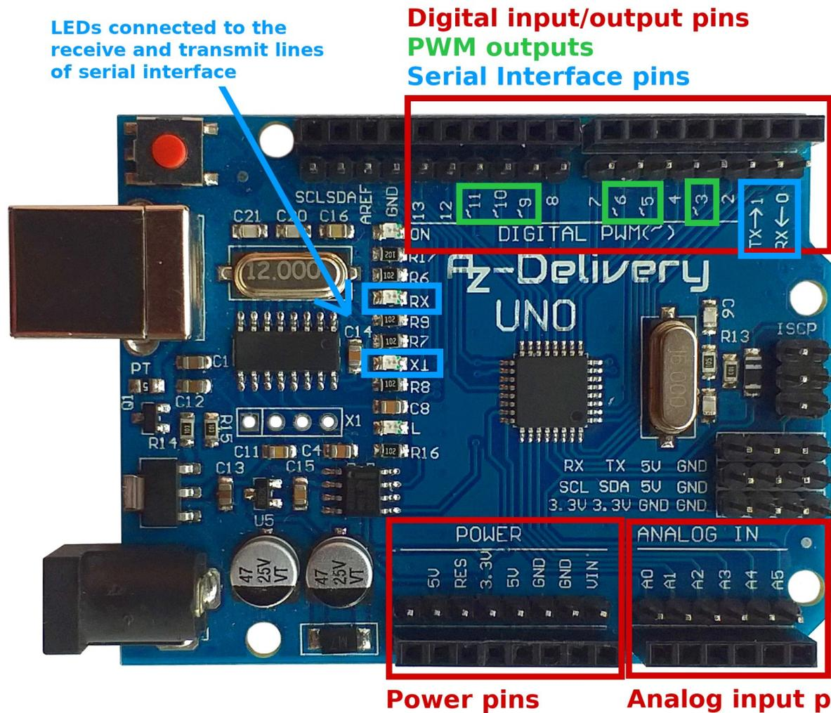
Der Uno ist so aufgebaut, dass digitale Ein-/Ausgangspins von analogen Eingangspins getrennt gruppiert werden. Es gibt also 6 analoge Eingangspins und getrennte 14 digitale Ein-/Ausgangspins. 6 von 14 digitalen Ein-/Ausgangspins können als PWM-Ausgänge (Pulsweitenmodulation) verwendet werden. Diese Pins sind mit dem Tildezeichen "~" gekennzeichnet (D3, D5, D6, D9, D10 und D11).
