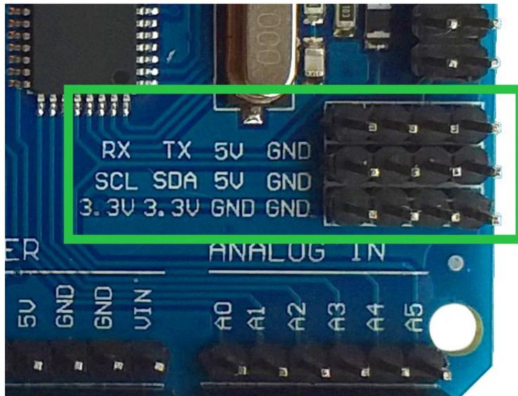
Unser AZ-Delivery UNO R3 verfügt ausserdem über die oben abgebildeten Pins. Diese können wie beschriftet verwendet werden.
