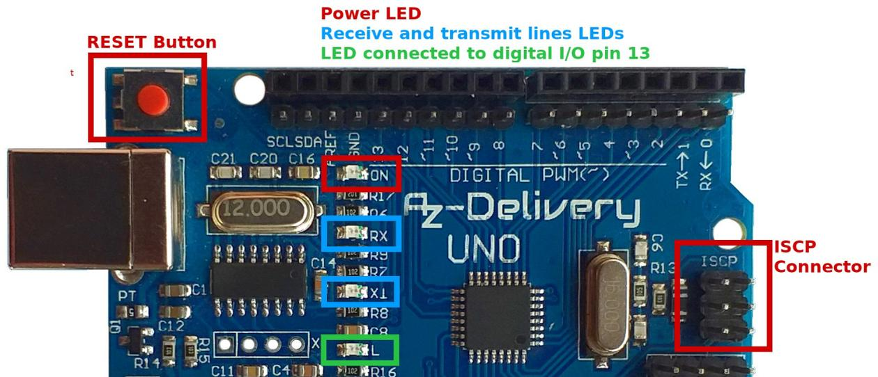
"OnBoard" des UNO gibt es eine Reset-Taste für den Hauptprozessor, vier LEDs sowie einen ICSP-Anschluss der zur externen Programmierung des ATmega328 dient.
