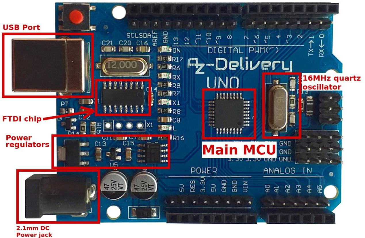
Der Uno R3 verfügt über eine ATmega328P CPU mit 16MHz. Der CH340 USB-Serial Chip stellt die Schnittstelle zwischen dem Mikrocontroller und Ihrem PC dar.
