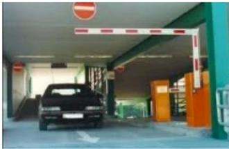
In Parkhäusern ist die Höhe eingeschränkt. Deshalb muss ein langer Schrankenbaum wie hier im Bild durch eine Vierer-Gelenk-Kette abgelenkt werden.
