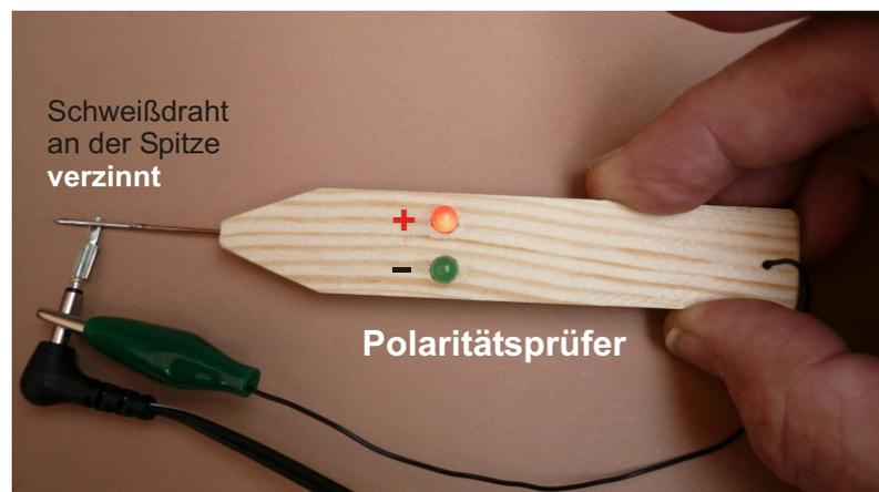
Jede LED lässt den Strom nur in einer Richtung durch. Mit dem Polaritätsprüfer kann man prüfen, wo der + oder -Pol einer Gleichspannungsquelle ist. (Besonders wichtig ist das, bevor man Elektrolytkondensatoren an die Stromquelle anschließt.)
