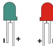
Achte darauf, dass die beiden Leuchtdioden mit unterschiedlicher Polung eingelötet werden!
