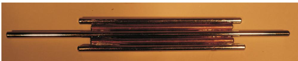
Rückseite des gelöteten Rotors
