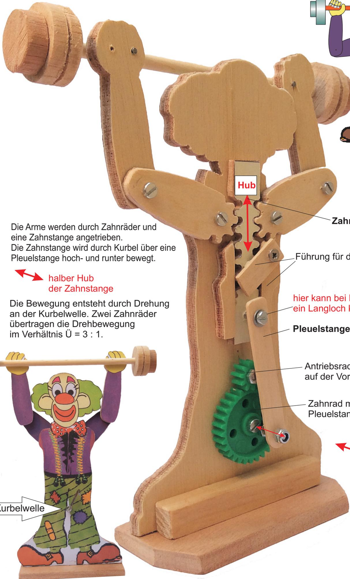
Die Arme werden durch Zahnräder und eine Zahnstange angetrieben. Die Zahnstange wird durch Kurbel über eine Pleuelstange hoch- und runter bewegt.
