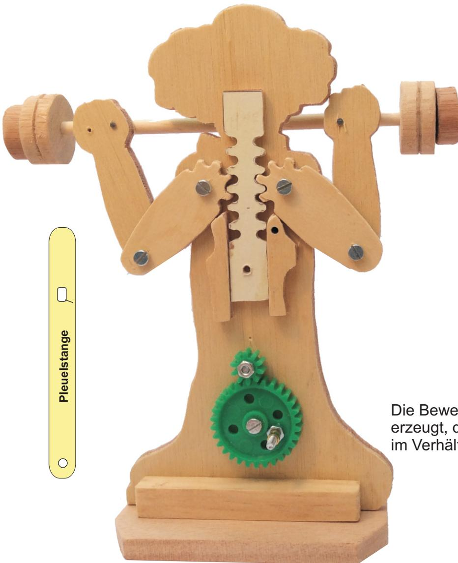
Die Bewegung wird durch eine Kurbelwelle erzeugt, die hier im Beispiel durch zwei Zahnräder im Verhältnis  $\ddot{U} = 3 : 1$  übertragen wird.
