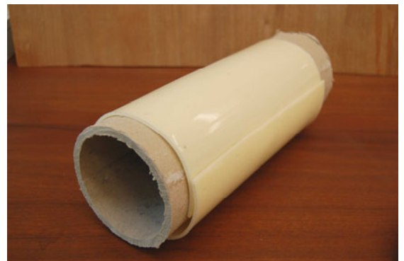
Biegen einer ganzflächig erwärmten Acrylglasplatte über einen Teppichkern
