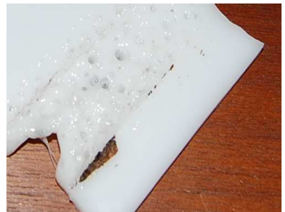
Beschädigte Oberfläche durch Überhitzung
