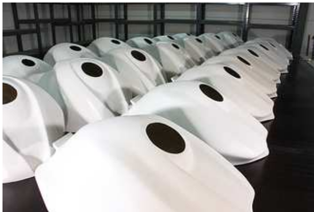
Seriengefertigte Tankhauben aus glasfaserverstärktem Kunststoff GFK
