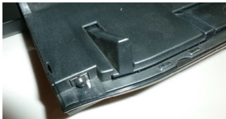
Verschiedene Arten von „Nasen“ an einer Druckerklappe
