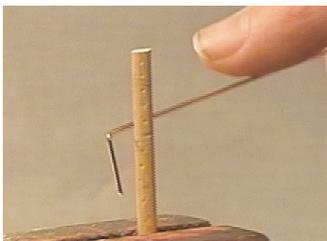
Schweißdraht rechtwinklig abbiegen und neben den eingespannten Rundstab in den Schraubstockschlitz stecken. Jetzt lässt sich bequem eine Spirale drehen.
