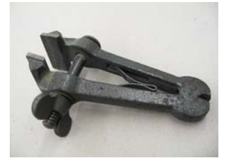
Feilkloben zum Halten kleiner Werkstücke
