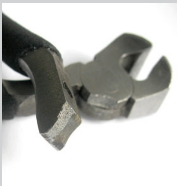
Bruchstelle einer Mosaikzange aus Gusseisen
