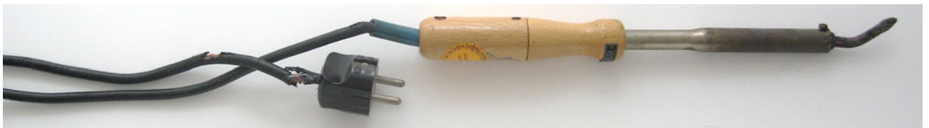
LötKolben mit lebensgefährlichem Anschlusskabel
