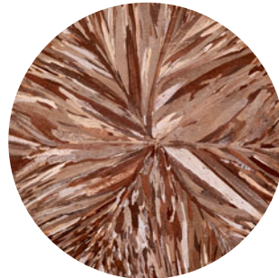
Metallgefüge nach dem Erstarren im Stranggussverfahren
