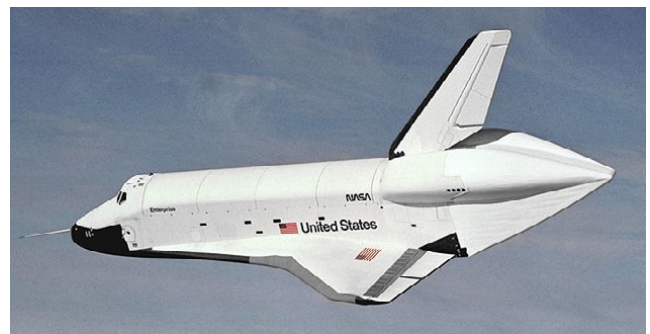
Space shuttle mit Keramik-Hitzeschildern als Außenhaut
