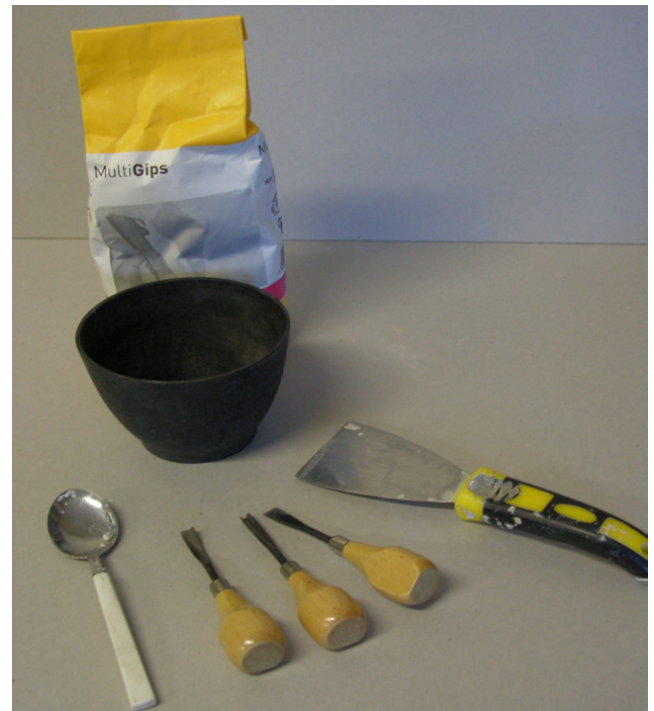
Werkzeuge und Hilfsmittel zur Gipsbearbeitung: Gummibecher, Spachtel, Schneide- und Schabwerkzeuge für subtraktives Arbeiten und Löffel zum Abmessen und Anrühren.
