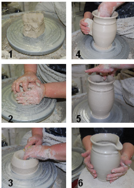
Die Arbeitsschritte beim Drehen eines Kruges
