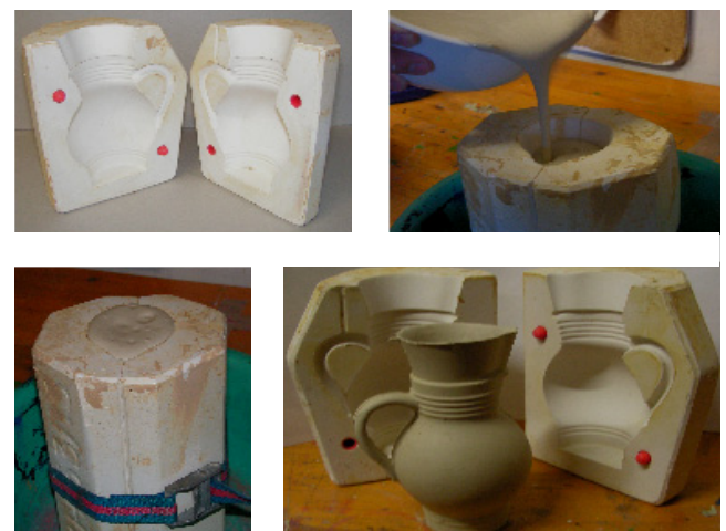
Abfolge der Arbeitsschritte beim Gießen eines Kruges
