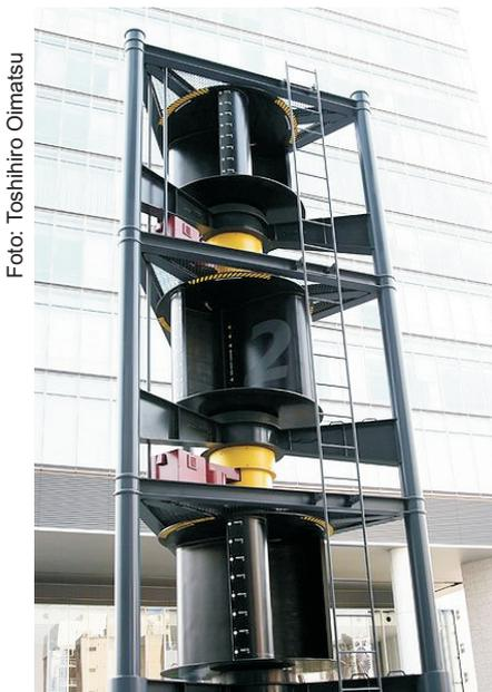
Savonius-Rotor, zur Glättung der Lastwechsel in mehrflügliger und gekoppelter Anordnung
